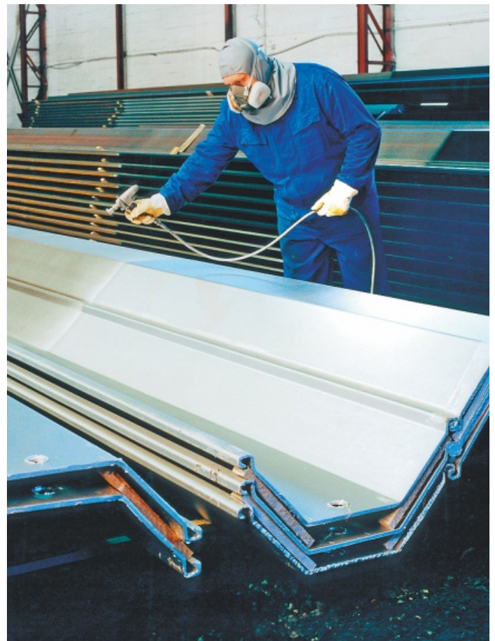
Werkseitige Spundwandbeschichtung Factory coating of sheet piling
